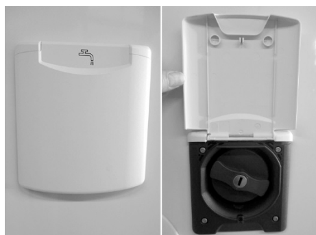
Fig. 76 : Manchon de remplissage d'eau fraîche
