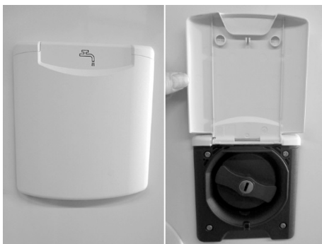
Fig. 20 : Manchon de remplissage d'eau fraîche
