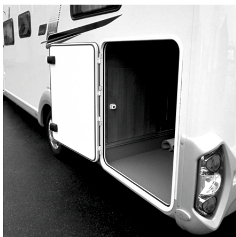
Fig. 18 : Exemple de cellule, casier de service extérieur : petit casier de rangement pour accessoires du véhicule ou de voyage fréquemment utilisés
